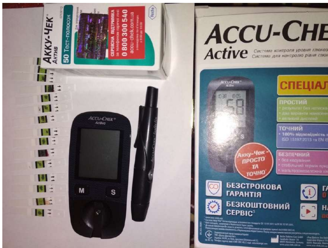
Рис.2.4 Система для вимірювання рівня глюкози в експерименті ( зліва направо: тест-смужки для вимірювання глюкози зі зразками крові щурів; глюкометр; оригінальна шприц-ручка)
